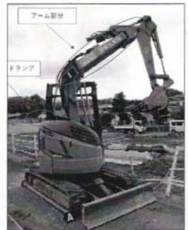
クレーン機能付き車両系建設機械
